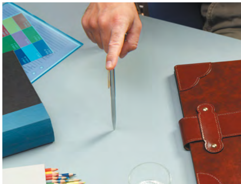
Skuggan i det här pennprovet visar att arbetsbelysningen är rätt placerad, för läs- och skrivarbete, det vill säga ljuset kommer snett bakifrån.
