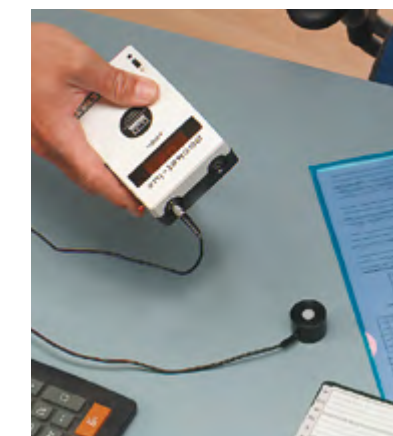
Belysningsstyrkan inom arbetsområdet och den omedelbara samt yttre omgivningen mäts med en luxmeter.
